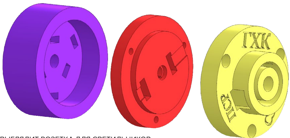
ТАК ВЫГЛЯДИТ РОЗЕТКА ДЛЯ СВЕТИЛЬНИКОВ, УСТАНОВЛЕННЫХ В «ГОРЯЧИХ» КАМЕРАХ НА РАДИОХИМИЧЕСКОМ ПРОИЗВОДСТВЕ 2 ПК ОДЦ С БЫСТРОСЪЕМНЫМИ КОНТАКТНЫМИ СОЕДИНЕНИЯМИ
