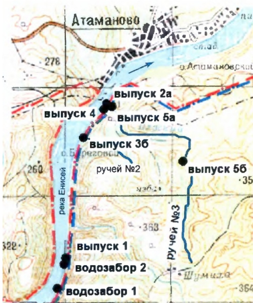
Рисунок 4.2.4 - Ситуационный план размещения мест забора водных ресурсов из реки Енисей и сброса сточных вод
